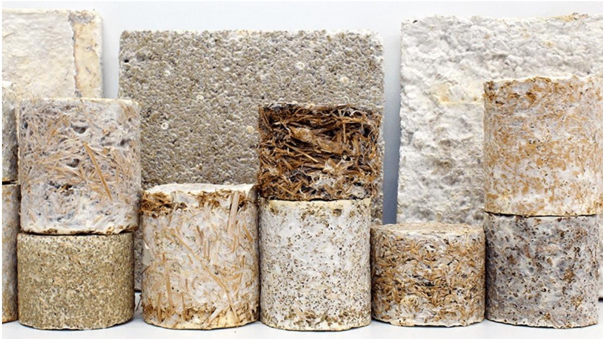
Abb. 2: Myzeldurchzogene Substrate nach der Trocknung
