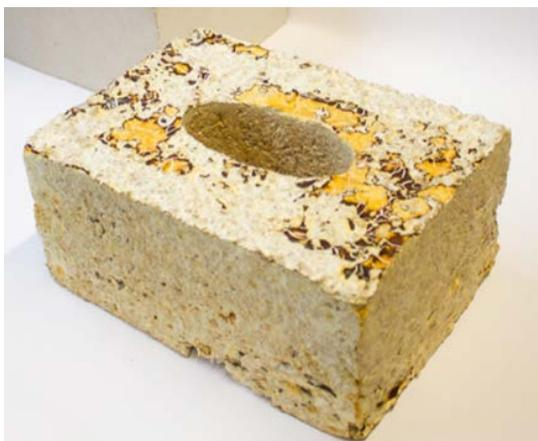
Abb. 10: Mauerstein aus Myzelkomposit
