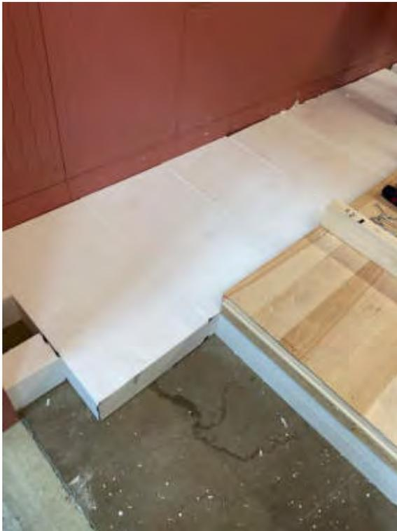
Abbildung 9: Isolation unter und seitlich vom Prüfobjekt
