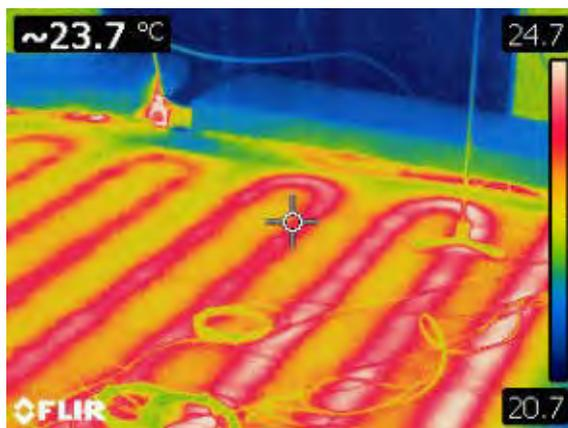
Abbildung 16: Heizungsrohre mit 240er Rohrabstand
