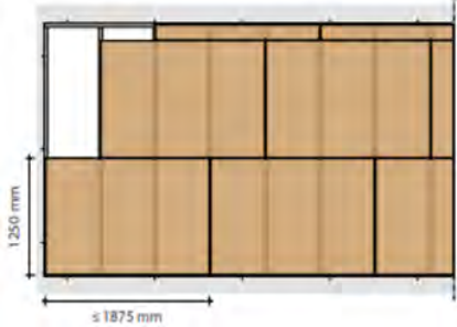
Abbildung 5 Beplankung der Trockenbauwand mit entsprechendem Fugenversatz. Jeder vertikale Plattenstoss muss auf einem Profil liegen
