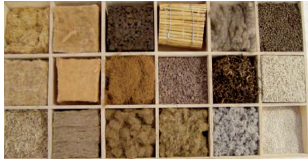
Abbildung 10 Dämmung aus nachwachsenden Rohstoffen: Von links nach rechts und von oben nach unten 1. Spalte: Stopfhanf, Thermohanf, Hanfschäben 2. Spalte: Jutedämmmatte, flexible Holzweichfaser, Flachs 3. Spalte: Korkdämmplatte, Kokosfaser, Neptunbälle 4. Spalte: Schilfrohr, lehmummantelte Holzspäne, Wiesengras 5. Spalte: Schafwolle, Seegras, Zellulose 6. Spalte: Blähton, Holzwolle, Perlite
