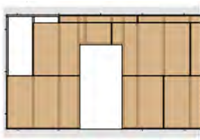
Abbildung 6 Beplankung mit Ausschnitt bei Türöffnung
